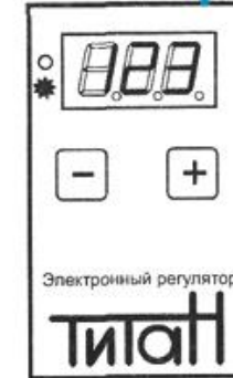
Рис. 2. Панель електронного регулятора котла «міні преміум».
